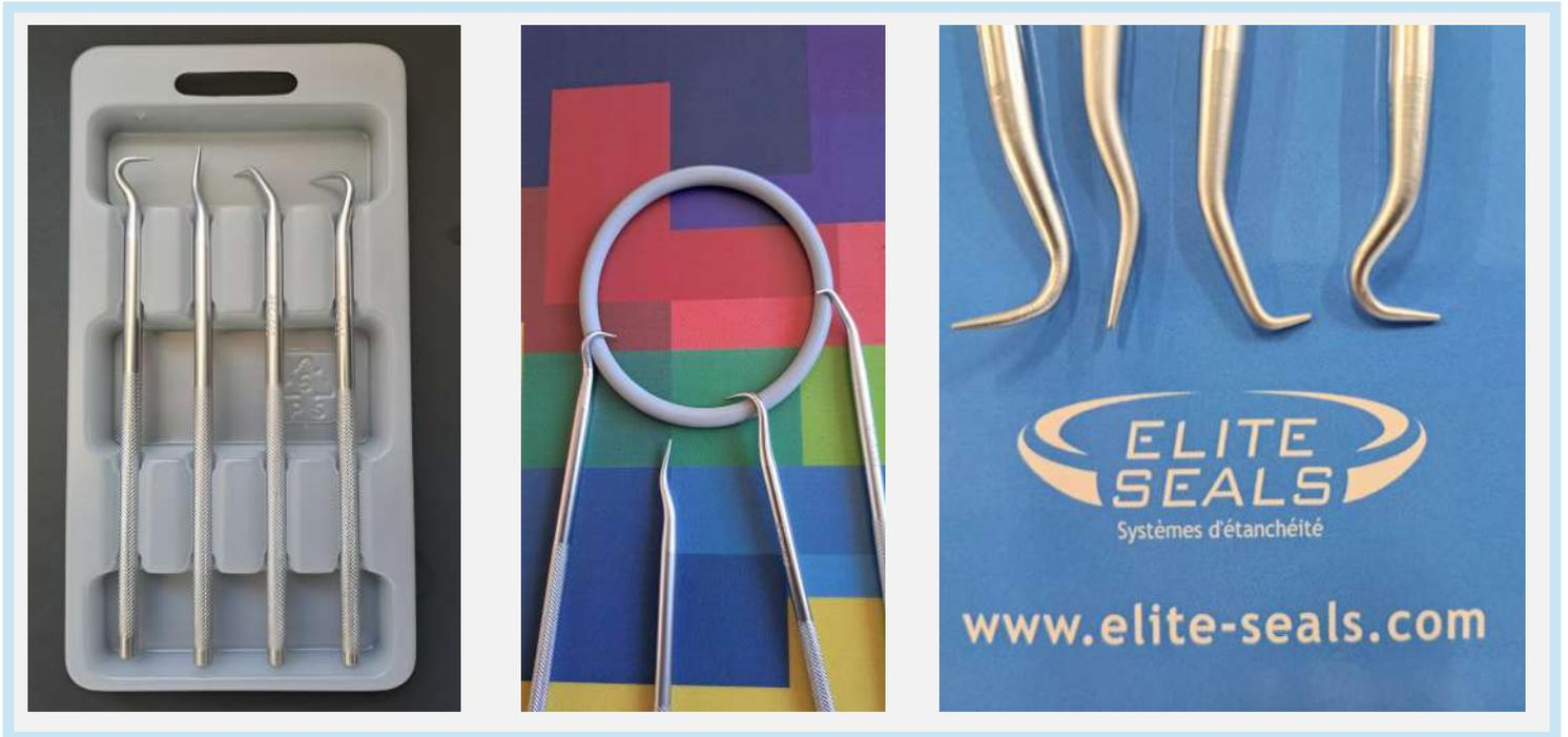
ODOR: Boite de 4 outils avec chacun une pointe fine et courbée différente pour aider à l'extraction des joints toriques de leur logement.
