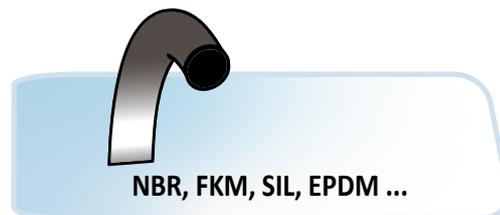
*Joint torique vendu au mètre (CORDE) et à utiliser uniquement pour des applications statiques.*
