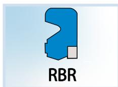
Le profil **RBR**, fonctionne comme anneau tampon ou «casse pression». Il a été spécialement conçu pour fonctionner comme joint principal et être associé à des joints à lèvres asymétriques (ex: RSA...)
