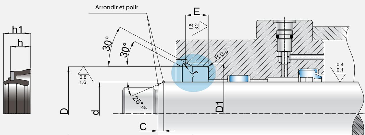
**La principale caractéristique du profil clipsable BWH/N est de permettre une installation facile et rapide dans un logement complètement ouvert. Son profil spécial, combinant joint et racleur est en NBR avec une âme métallique vulcanisée à l'intérieur. Après le montage du joint dans son logement ouvert, positionner un circlip dans la rainure devant celui-ci pour éviter l'éjection du joint pendant les cycles.**
