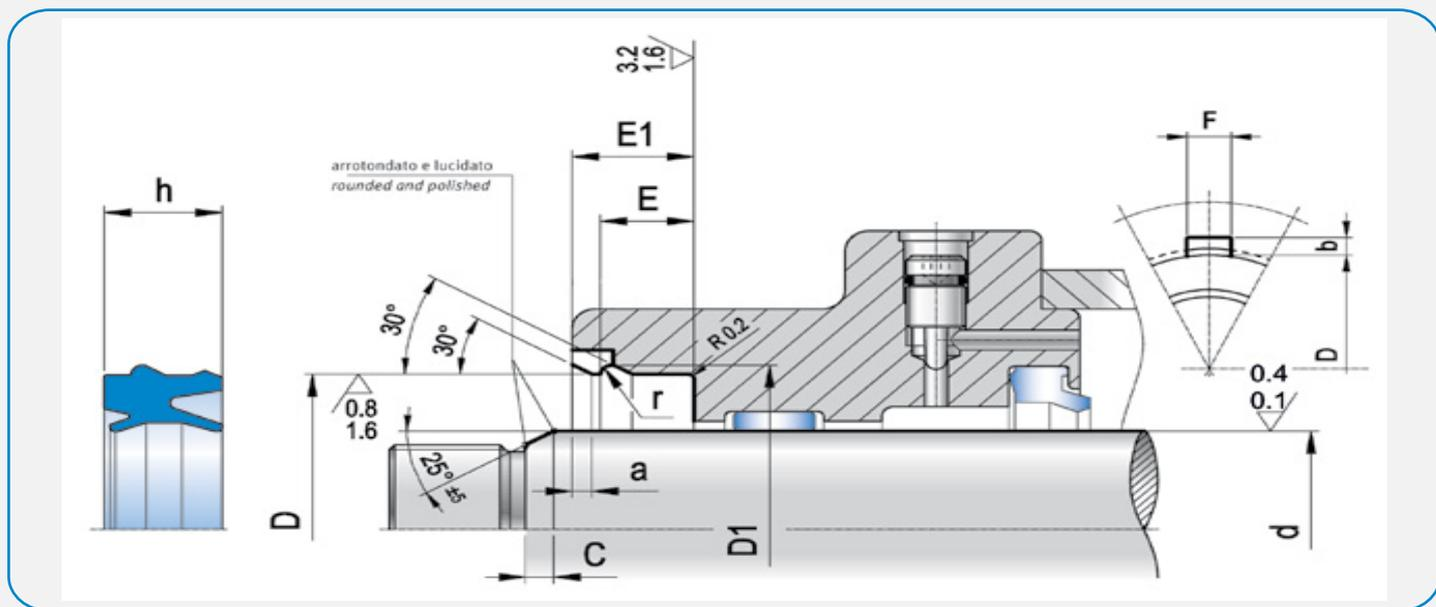
La principale caractéristique du profil clipsable BWH est de permettre une installation facile et rapide dans un logement complètement ouvert, à la fois automatiquement et manuellement.
