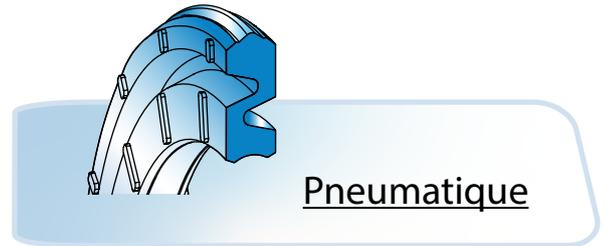
Le profil spécial du SPS en forme de ressort assure une grande flexibilité dans le système, même à basse pression avec un encombrement réduit. Joint double effet. Sa forme symétrique facilite son montage.
