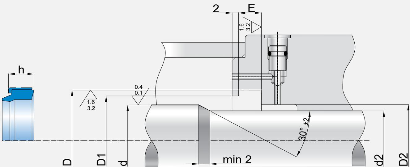
le joint d'amortissement CSA est conçu pour le freinage en fin de course des vérins pneumatiques.
