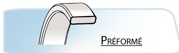
**La fonction des segments de guidage préformés est de maintenir l'alignement de toutes les pièces mécaniques du vérin. Ils aident l'ensemble des joints à travailler sans désalignement, et ils empêchent tout contact entre les pièces en métal.**
